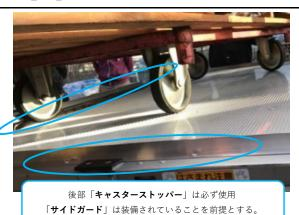
昇降作業では荷物が崩れる事故の危険性がある為、危険個所の事前チェック・安全装置の使用・等の安全対策を実施する。
