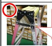
安全装置を正しく使用 安全装置が ロックするまで開く
